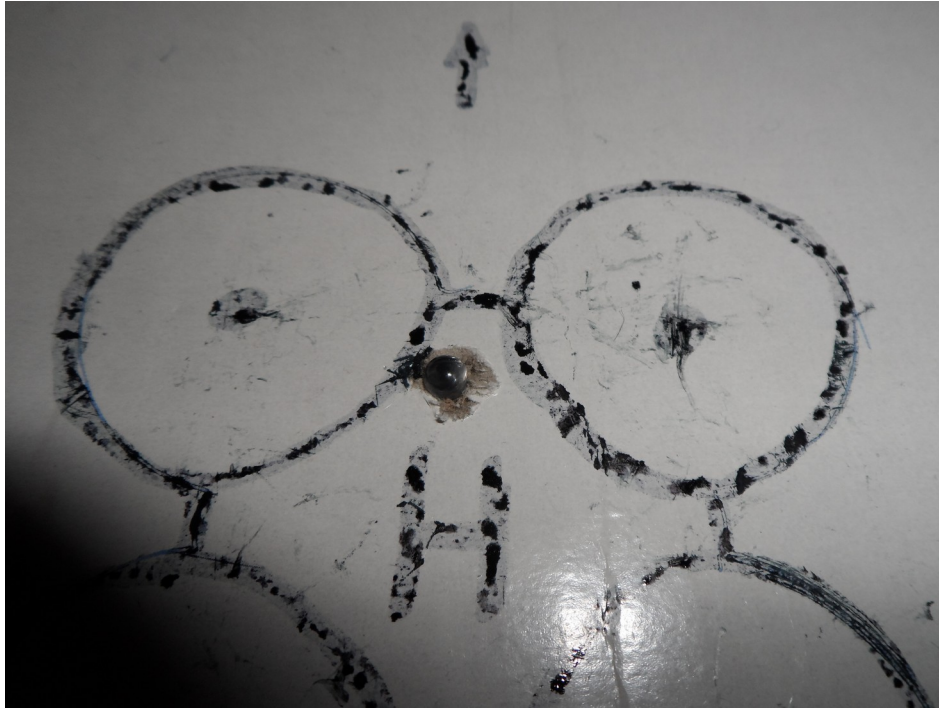
Abbildung 8: Der Fototransistor zur Landeerkennung
